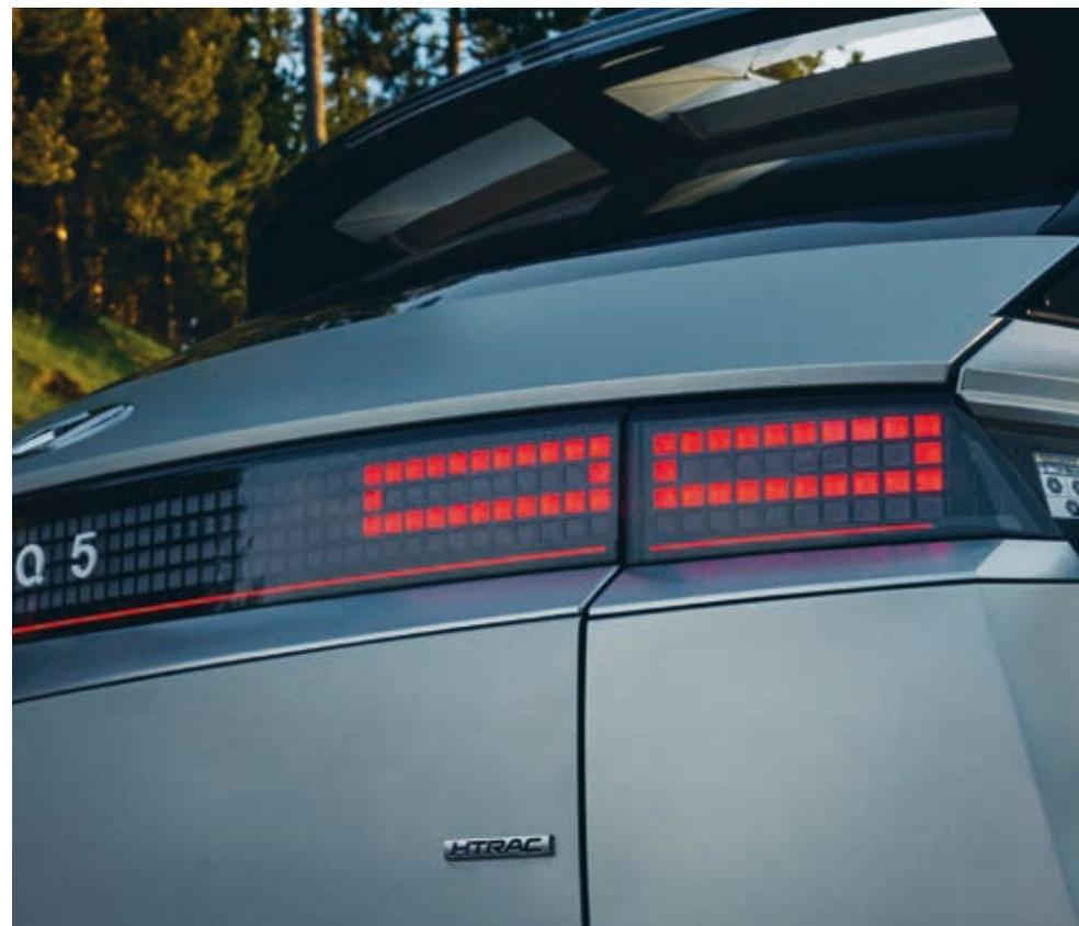
Luces traseras con diseño de píxeles paramétricos.
