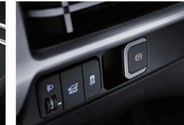
Freno de estacionamiento electrónico (EPB)
