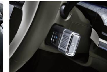
Cambio electrónico tipo columna (SBW)
