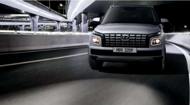
Luces estáticas de curva Superan la limitación de los faros convencionales al iluminar zonas laterales al tomar una curva a baja velocidad. Se activan automáticamente con un giro del volante.
