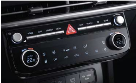
Sistema de aire acondicionado totalmente automático
